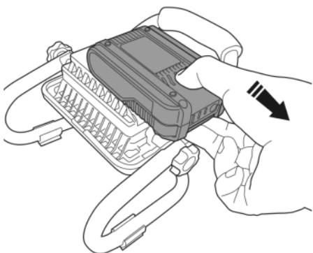
K odstranění akumulátoru stiskněte odblokování na akumulátoru.
